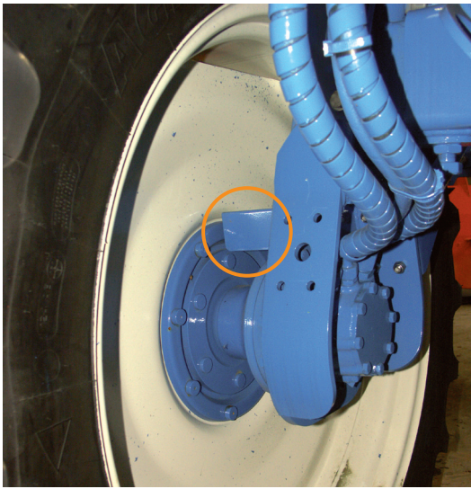
▲ Capteur de vitesse d'avancement
