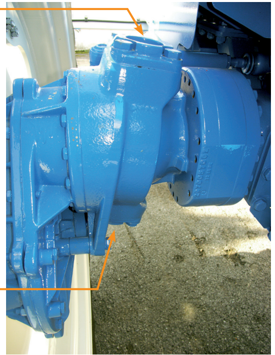
Pivot de pont arrière droite ▲
