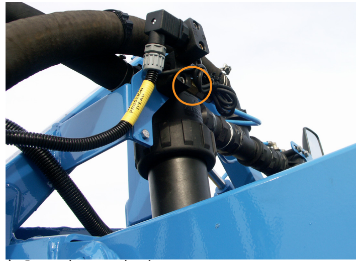
▲ Capteur de pression de pulvérisation
