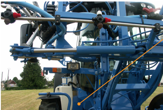
▲ Manomètre ① et débitmètre ② de pulvérisation
