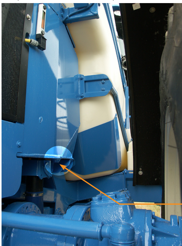
Bouchon de vidange d'huile hydraulique
