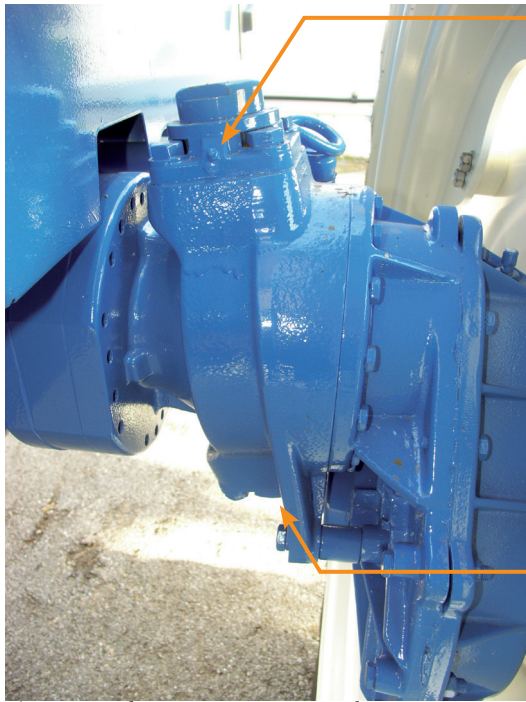
▲ Pivot de pont arrière gauche
