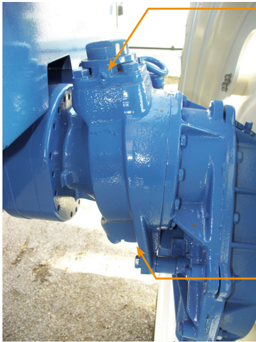
▲ Pivot de pont arrière gauche
