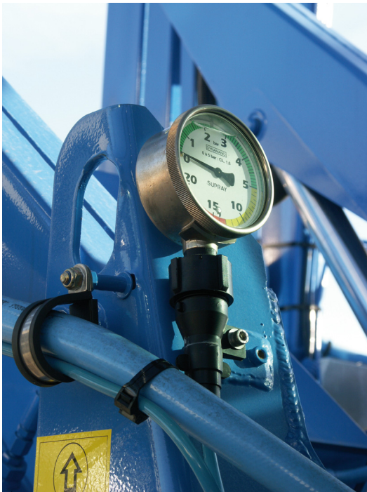
▲ Manomètre et capteur de pression de pulvérisation ▼.
