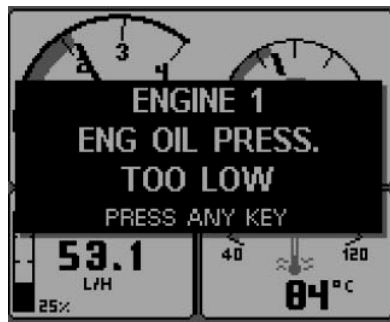
Exemple de message d'alarme pour la pression d'huile
